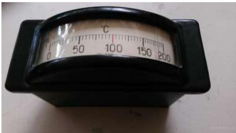
Для контроля температуры в зоне реакции по месту использовались логометры ЛПР-53, установить которые пришлось на взрывобезопасной лестничной площадке (искробезопасные логометры еще не выпускались).
