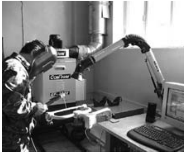
Аппарат, имитирующий сварку, контролируется компьютером. Фото автора.
